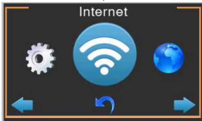
Der Pelletofen Vittoria PBS kann mit einem WLAN-Modul ausgestattet werden. Er kann sich in ein bestehendes WLAN-Netzwerk einbuchen und sich mit unseren CLOUD-Server verbinden. Er sendet sämtliche Betriebsinformationen bzw. kann auch einfache Befehle empfangen. Um diese Funktionen zu nutzen muß der Pelletofen für den Internet-Zugriff eingerichtet werden.
